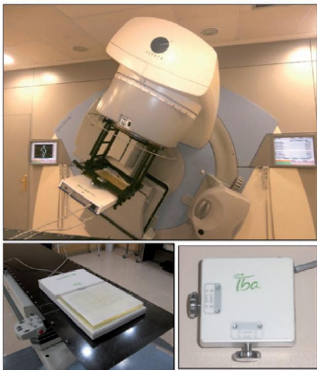
**Fig. 1.** En la parte superior se observa el detector MatriXX Evolution acoplado al cabezal de la unidad de tratamiento. En la parte inferior, a la izquierda, se muestra un detalle del detector dispuesto con el espesor de equilibrio empleado en la rutina de medida. A la derecha se observa el sensor empleado para referenciar la información angular.
