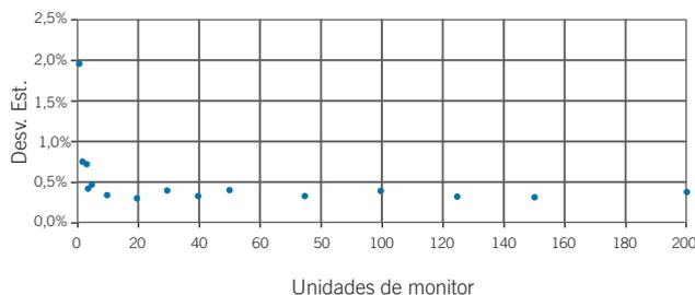
**Fig. 2.** Reproducibilidad de la señal. Cociente entre la desviación estándar de los valores de las cuatro medidas efectuadas en distintos días para cada número de unidades de monitor y su valor promedio.
