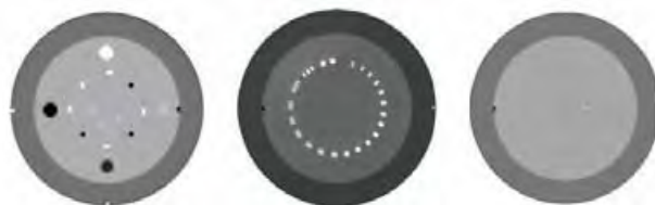
Fig. 12. Imágenes del maniquí CatPhan . La imagen de la izquierda permite verificar la exactitud de los números de TC y la detectabilidad de bajo contraste. La imagen central corresponde al módulo de resolución espacial. La imagen derecha sirve para obtener la PSF y para verificar la uniformidad espacial del número de TC.
