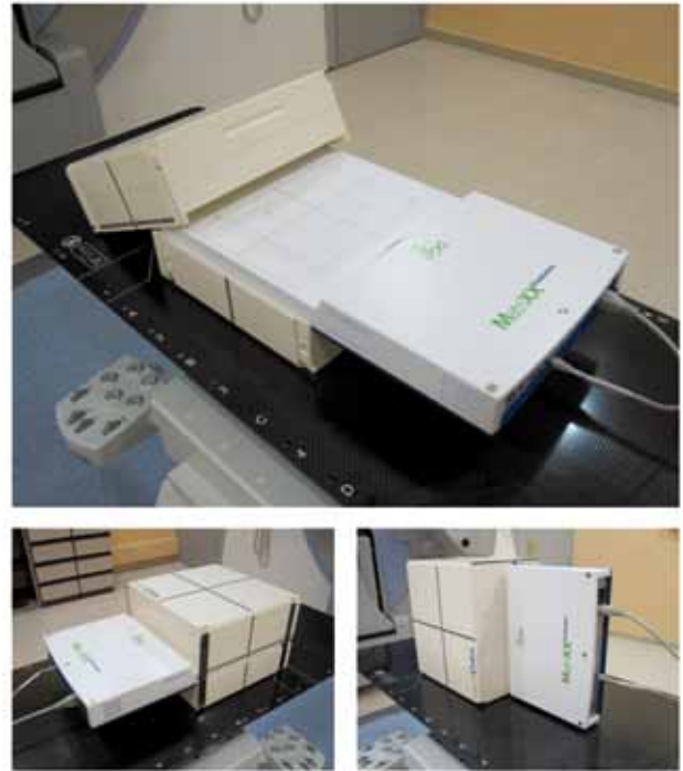
Fig. 3. En la parte superior se aprecia el montaje de la matriz de detectores en el interior del maniquí cúbico MultiCube. Se puede observar en las figuras inferiores la disposición del conjunto MatriXX + MultiCube para las medidas de planos coronales y sagitales, respectivamente.
