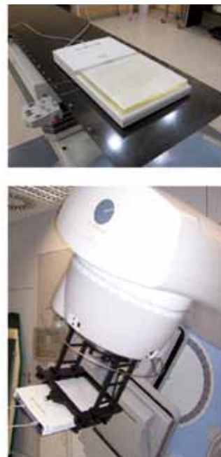
Fig. 2. En la parte superior se observa el detector MatriXX Evolution sobre la mesa de tratamiento. En la parte inferior el detector aparece acoplado al cabezal del acelerador con la ayuda del aditamento adecuado.
