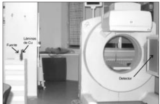
Fig.4. Configuración para la determinación de la curva de respuesta temporal por el método de reducción de la distancia.
