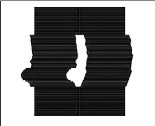
Fig. 12. Colimador Multilamina de resolución física de 5 mm.
