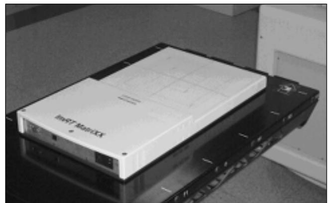
Fig. 1. Equipo MatriXX. Las 1020 cámaras de ionización cubren uniformemente un área de 24x24 cm<sup>2</sup>. El diámetro de cada detector es de 4,5 mm y tiene una altura de 5 mm. La distancia entre detectores adyacentes es de 7,62 mm.
