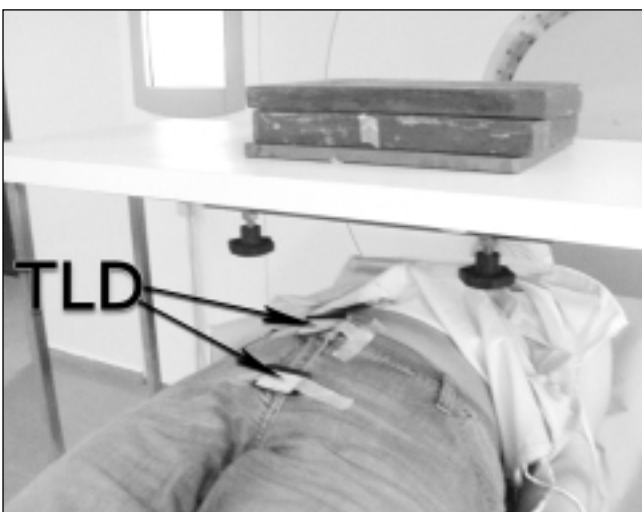
Fig 3. Vista del blindaje superior en posición y situación de los dosímetros para medir la dosis en piel.
