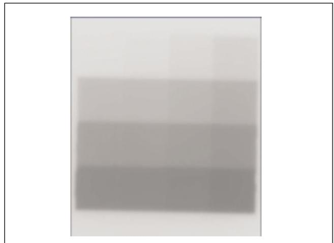
Fig. 1. Película irradiada con 16 puntos de dosis conocidas para obtener la curva de calibración.
