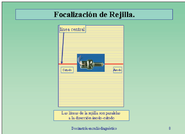
Fig. 1. Situación de las líneas de la rejilla respecto de la dirección ánodo-cátodo.
