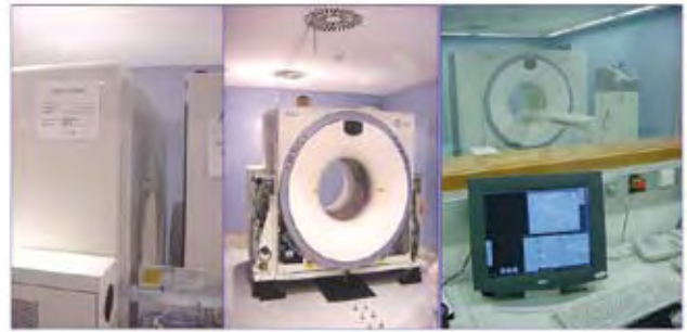
Fig. 2. Tomógrafo PET/CT (Biograph 2 de Siemens) instalado en la Clínica Universidad de Navarra. En las dos primeras imágenes, que corresponden a la fase de montaje, se observa la disposición en tándem del PET y del CT.
