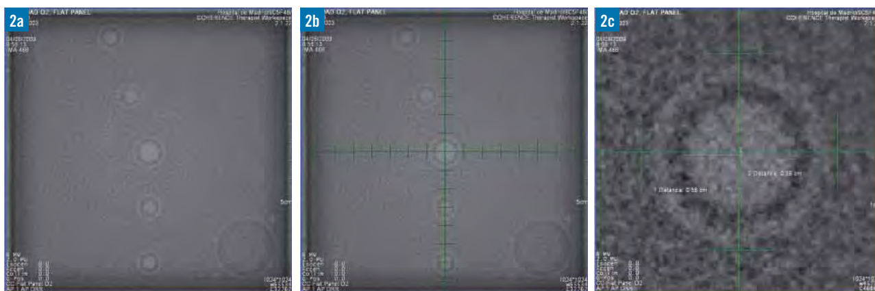
Fig. 2. a) Imagen de la proyección AP del maniquí Penta-Guide; b) visualización de la cruceta que se sitúa sobre el centro de la imagen; c) medida de las distancias entre los bordes de la esfera central y dicha cruceta.
