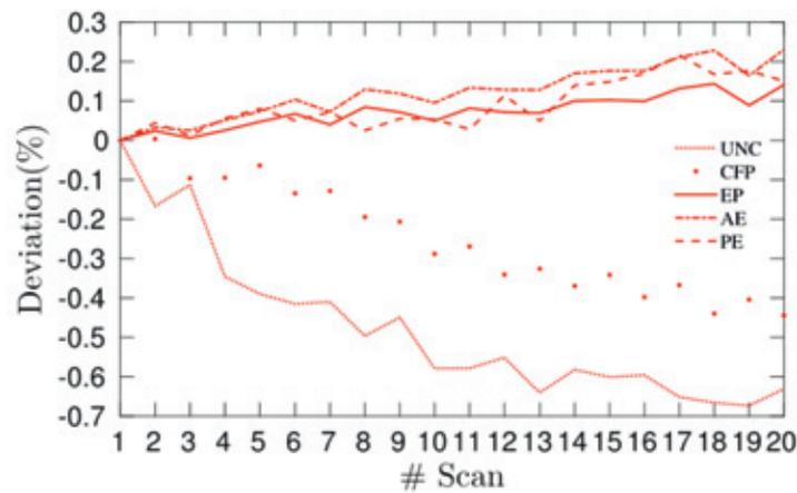
**Fig. 2.** Precisión de la estimación de dosis a lo largo de 20 escaneos consecutivos respecto a la primera digitalización en el canal rojo sin uso de métodos correctivos (UNC), con utilización de compensación con trozo de control (CFP), con uso de protocolo eficiente (EP), uso de escalado de ejes (AE) y uso de escalado de parámetros (PE).
