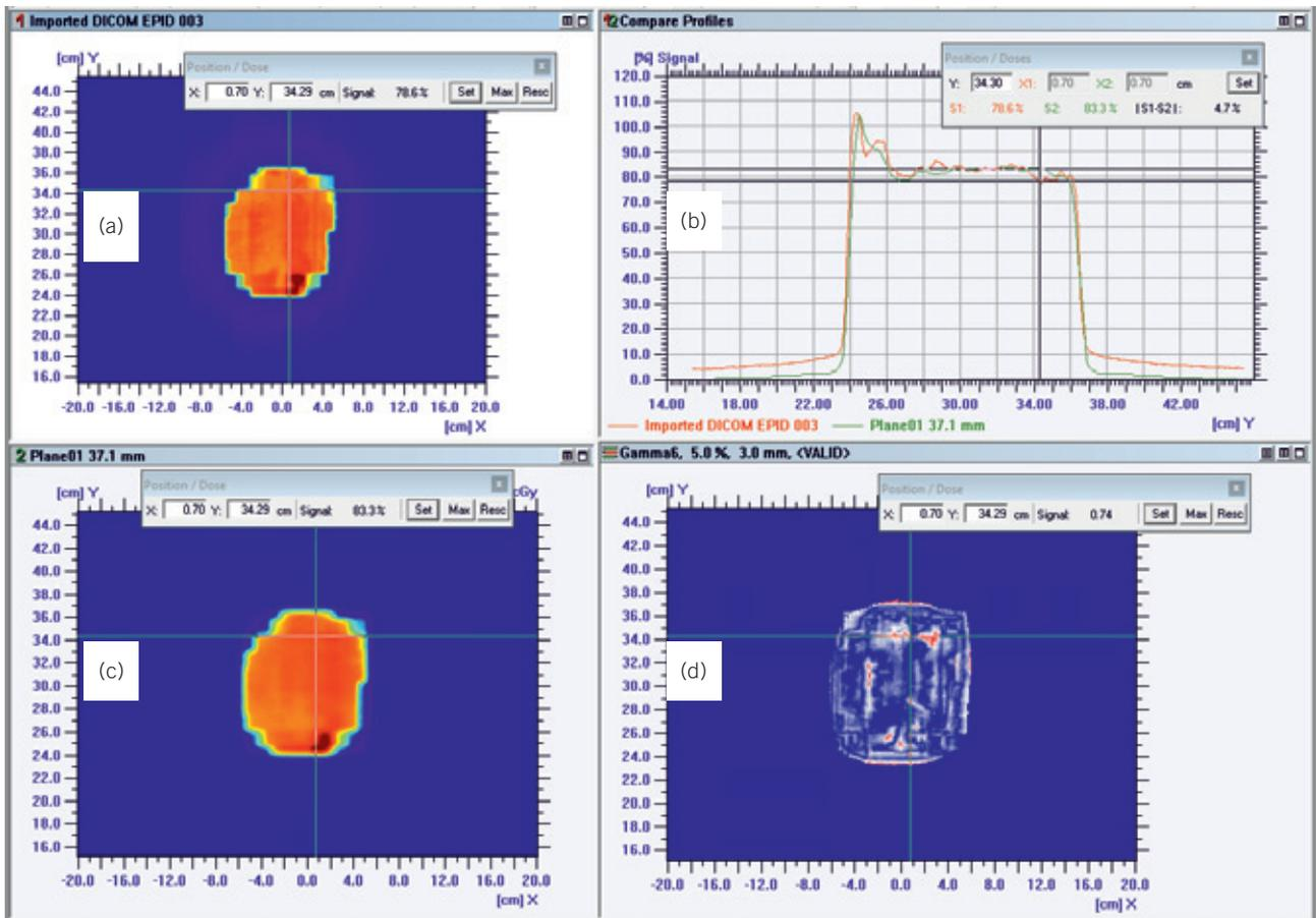
**Fig. 2.** Campo de tratamiento de próstata IMRT a través de maniquí antropomórfico. (a) medida obtenida con el EPID, (b) perfil craneo-caudal, (c) distribución calculada por el planificador, (d) resultado del análisis gamma (5%, 3 mm).
