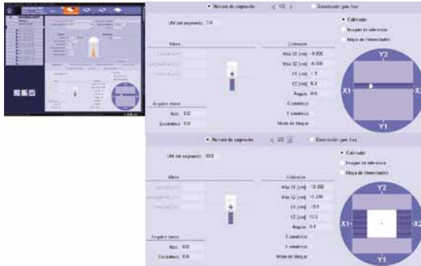
Fig. 1. Capturas de pantalla de la aplicación Syngo que muestran la IMRT de dos segmentos por campo empleada para realizar las medidas. En la parte izquierda se puede apreciar la serie de doce campos que se diferencian en las unidades monitor del segundo segmento.
