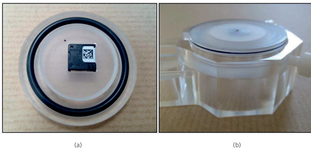
Fig. 2. (a) Colocación del dosímetro en el inserto cilíndrico de PMMA. (b) Colocación del inserto en el soporte de cámara tipo Roos. El punto de la cara superior del inserto indica el centro del material sensible del dosímetro. La línea negra del lateral indica la profundidad efectiva del material sensible del dosímetro.
