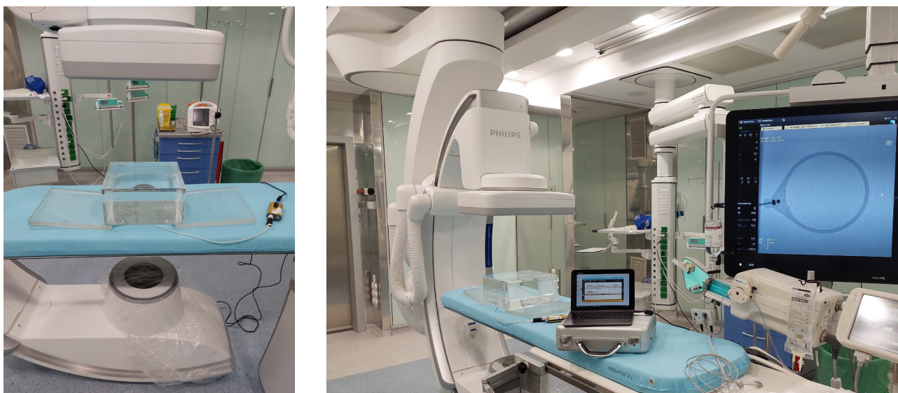
Fig. 2. a. Montaje experimental. Visión general del montaje experimental. La mesa se coloca a dos alturas, a la del IRP o IRP más 11 cm. La mesa se mueve horizontalmente para que la cámara de ionización quede siempre centrada en el campo de radiación. b. Montaje experimental. Detalle de la colocación del maniquí de agua y la cámara de ionización sobre la mesa del paciente. La cámara se coloca encima de la colchoneta y en contacto con la cara inferior del maniquí.
