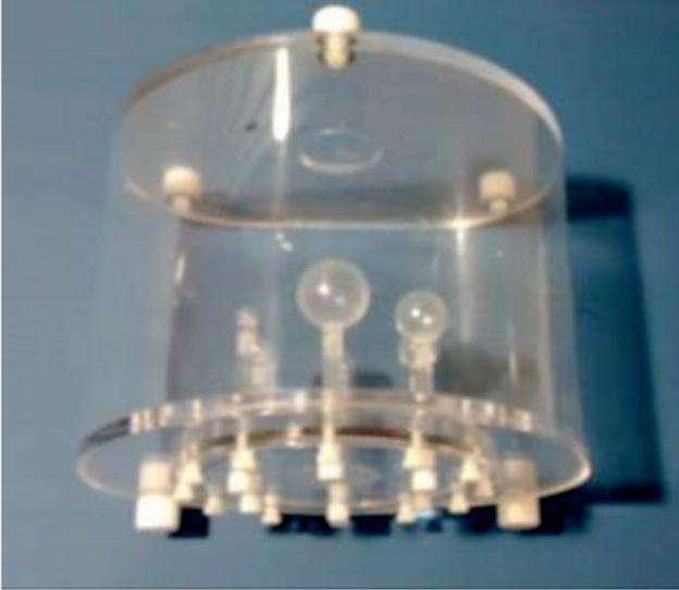
Fig. 2. Maniquí de esferas NEMA IEC *Body Phantom*.
