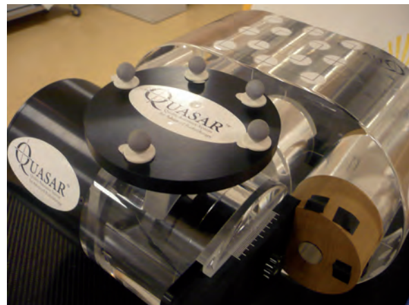
Fig. 4. Maniquí QUASAR Test Motion Assay empleado en la evaluación de la dosis absorbida en condiciones de control respiratorio mediante un inserto específico para cámara de ionización en el cilindro de madera que simula una cavidad heterogénea equivalente a tejido pulmonar.
