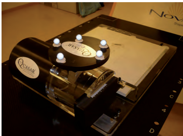
Fig. 3. Maniquí QUASAR Respiratory Motion Platform utilizado en el estudio de la influencia del ciclo respiratorio en la localización y posicionamiento del isocentro de tratamiento, la evaluación de las distribuciones de dosis absorbida y el estudio de viabilidad de tratamientos de IMRT en condiciones de control respiratorio.
