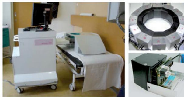
**Fig. 1.** Izquierda: prototipo MAMMI. Derecha superior: anillo de detección MAMMI. Derecha inferior: módulo de detección.
