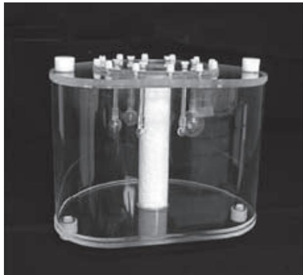
**Fig. 1.** Maniquí “NEMA/IEC 2001 Body Phantom” específico para control de calidad en PET.
