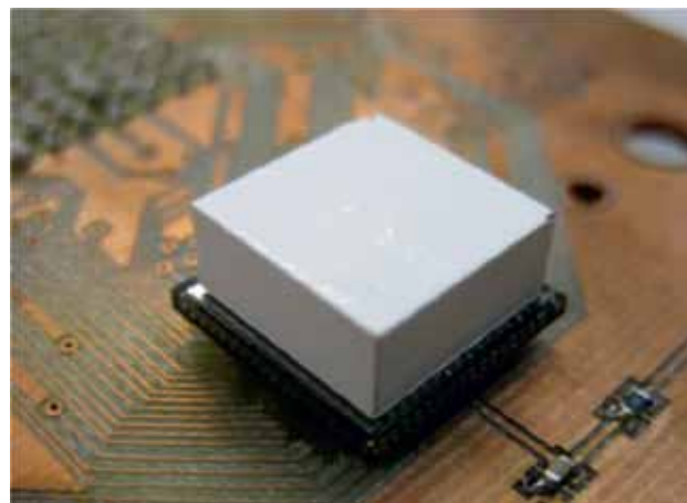
Fig. 1. Cristal centelleador continuo pintado de blanco acoplado a un SiPM.
