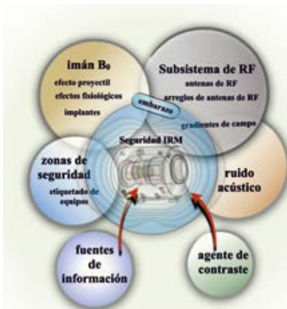
Fig. 1. Esquema simplificado de la seguridad en IRM y sus efectos producidos por el imán superconductor, 11-13 las antenas compensadoras de la uniformidad del campo estático, las bobinas de gradiente de campo magnético 14-15 y antenas de RF del tipo jaula de pájaro. 16-17 En cada caso también se anotan los efectos que se producen durante su funcionamiento para adquirir la imagen, y otros factores como el ruido acústico, agentes de contraste y embarazo.
