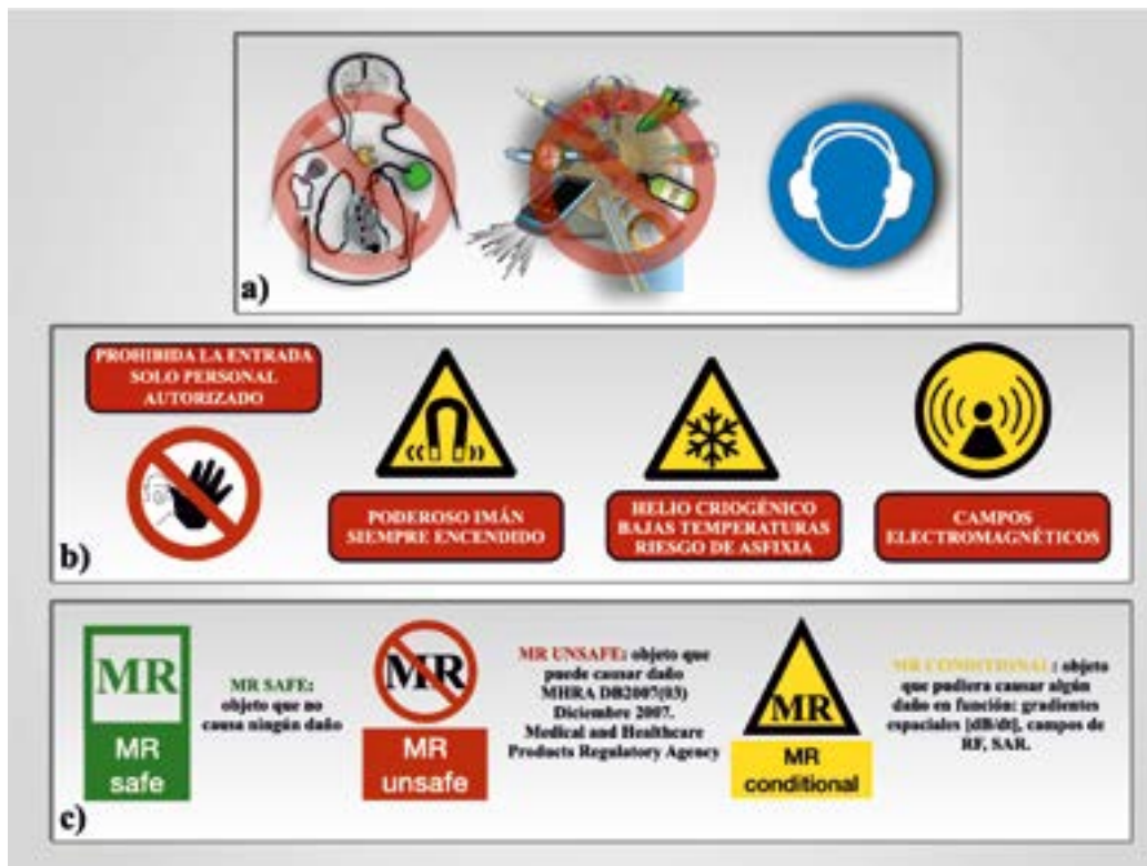
Fig. 10. Señalización estándar para colocar en la puerta de acceso al cuarto del imán (Zona 4 de la Fig. 9) en (a) y (b). Esta información está basada en material producido por el Instituto de Física e Ingeniería en Medicina (Institute of Physics and Engineering in Medicine: www.ipem.ac.uk ). c) Etiquetado para los dispositivos empleados con los sistemas clínicos de IRM de acuerdo a su compatibilidad.
