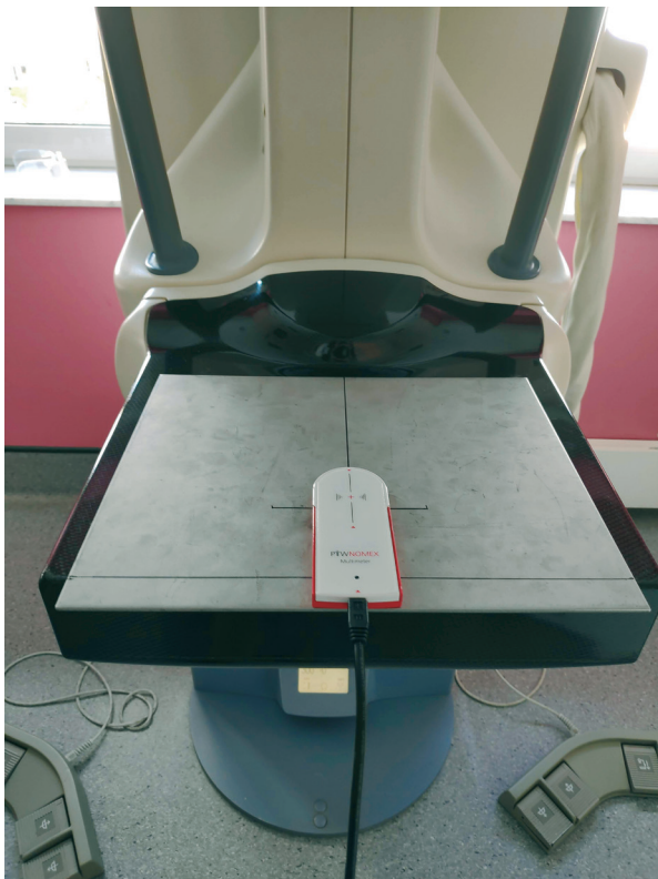
Fig. 1. Montaje del detector semiconductor NOMEX Multímetro (PTW).
