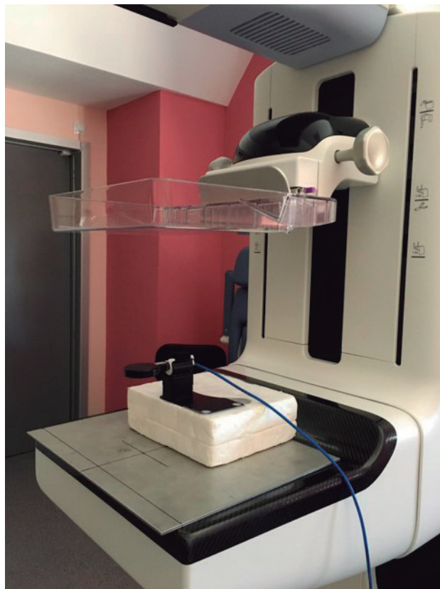
Fig. 2. Montaje de la cámara de ionización (PTW).
