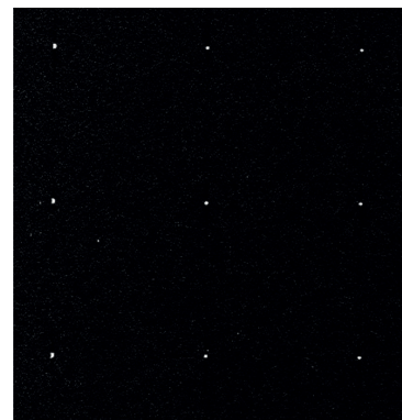
Fig. 2.12. Variación del plano en foco en la dirección perpendicular al movimiento del tubo de rayos X debido a la curvatura del soporte de la mama (Sistema Siemens Mammomat). Se puede apreciar como las esferas situadas en la columna de la derecha (lado de la pared costal) se ven de forma nítida mientras que las situadas en la columna de la izquierda tienen una forma alargada.
