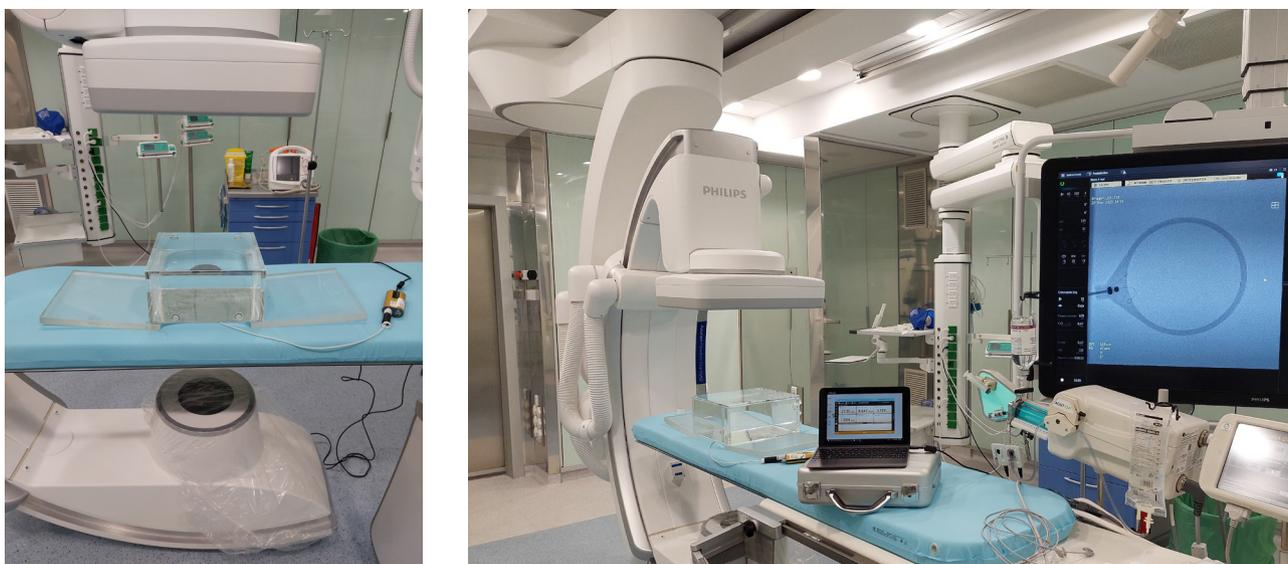
**Fig. 2.** a. Montaje experimental. Visión general del montaje experimental. La mesa se coloca a dos alturas, a la del IRP o IRP más 11 cm. La mesa se mueve horizontalmente para que la cámara de ionización quede siempre centrada en el campo de radiación. b. Montaje experimental. Detalle de la colocación del maniquí de agua y la cámara de ionización sobre la mesa del paciente. La cámara se coloca encima de la colchoneta y en contacto con la cara inferior del maniquí.
